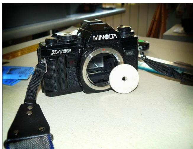
Le minuscole dimensioni del foro determineranno una scarsissima luminosità e tempi di posa conseguentemente molto lunghi. In compenso vi assicuro la profondità di campo sarà praticamente illimitata. Lavorando in pieno sole, si potranno usare anche tempi abbastanza rapidi per poter scattare a mano libera anche se personalmente preferisco sempre utilizzare un buon cavalletto. Anche perché non c'è nessuna fretta.
